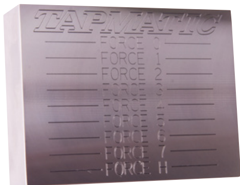
Beispielmarkierung auf wärmebehandeltem Material 4140 mit einer Härte von 28 HRC. Die Komprimierung betrug 1,3mm.
