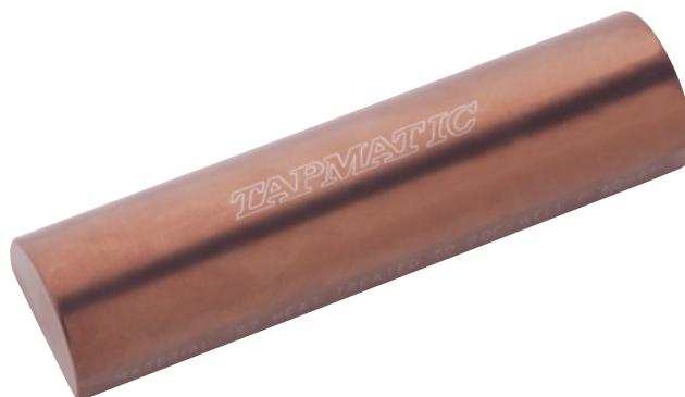
Beispielmarkierung einer abgerundeten Fläche, bei konstanter Arbeitsebene. Material ist S7 Werkzeugstahl, wärmebehandelt auf 60 HRC. Einstellung 'H' mit 2mm Komprimierung.
